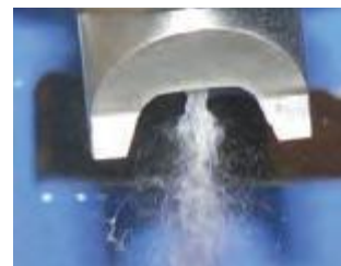
Abbildung 11: Zerstäubung von Gelatine mit einer Lechler ViscoMist Zweistoffdüse
